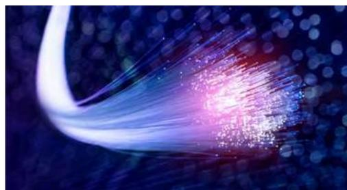
As fibras ópticas são usadas para transmitir dados de telefonia e também de internet. As fibras ópticas são fios transparentes que transportam as informações de forma mais eficaz que cabos metálicos convencionais. Elas funcionam a partir do fenômeno da reflexão interna total da luz que se propaga constantemente em seu núcleo interno, possibilitando poucas perdas de sinal.
